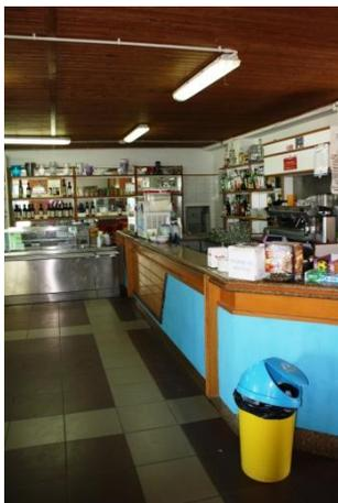
Il **bar e ristorante** è raggiungibile tramite un piccolo gradino di 2 cm. La larghezza utile della porta d'ingresso è superiore a 90 cm. Fra il bar e il ristorante/self service è presente uno scalino di 8 cm (vedi foto sopra). Il banco del bar presenta una parte ribassata (<100 cm). Il banco del buffet (self-service) è alto da terra 60 cm. I Tavoli sono a 4 gambi e l'altezza utile sotto il tavolo per accostamento carrozzina è di 88 cm.
