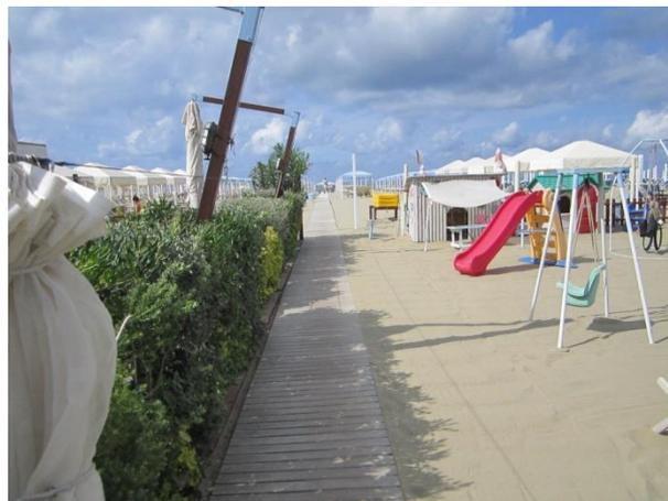
La spiaggia è in concessione, raggiungibile, dall'ingresso principale, tramite una prima rampa, la stessa che conduce alla piscina: lungh. 3 m, largh. >100 cm, con pendenza 16%; poi si scende una 2° rampa lungh. 3 m, largh. >100 cm, con pendenza 16%.
