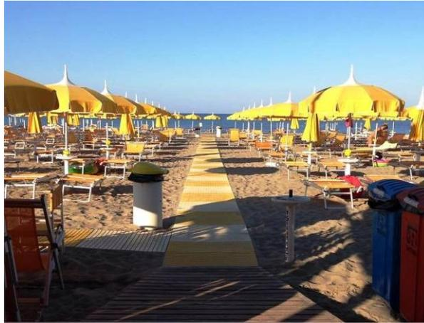
La spiaggia è in concessione, raggiungibile tramite rampa: lungh. 300 cm, largh. 100 cm (parte più stretta) e 200 cm (parte più larga), pendenza 5%.
