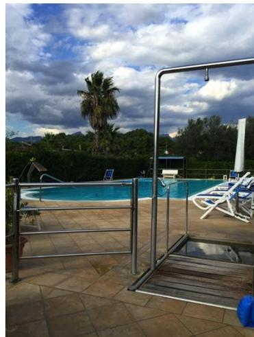
La struttura dispone di una piscina raggiungibile superando una rampa con pendenza 5 % c.a.. La pavimentazione è liscia; per accedere all'interno della vasca vi è la scaletta metallica o una scalinata interna. La profondità della vasca è 110/180 cm ed il bordo è a sfioro.
