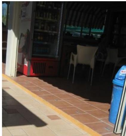
Il **bar** è all'aperto, accessibile in piano, ma lungo il perimetro troviamo uno scalino di 6 cm. Il bancone è alto 110 cm, i tavoli sono a 4 piedi e l'altezza utile da terra al piano sottostante è di 64 cm.
