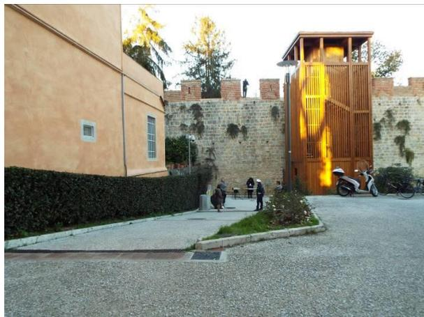
**Torre di Legno** in piazza Federico del Rosso si raggiunge da Lungarno Buozzi, angolo con Via del Borghetto, attraverso un varco ampio, un tratto in asfalto e successiva rampa di 13,60 metri, con pendenza 8 %. Le mura sono raggiungibili attraverso le scale superabili da una persona in carrozzina tramite un elevatore, con portata complessiva 350 kg.
