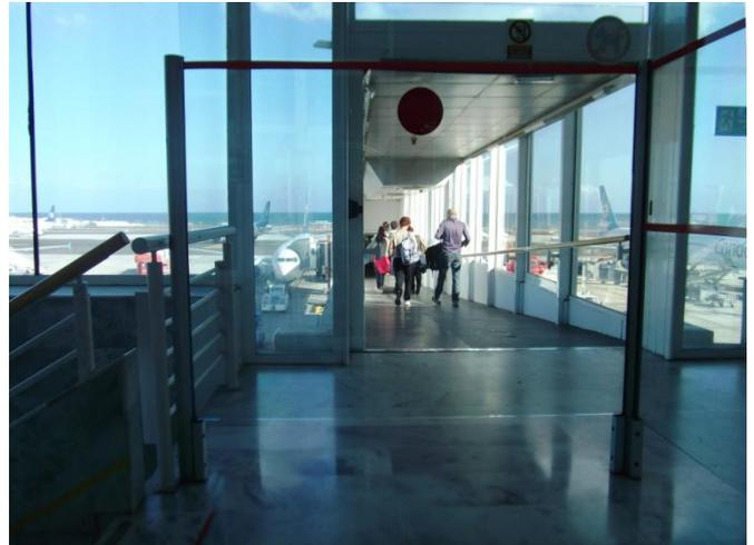
L'Aeroporto di Siviglia si sviluppa su due piani. Gli imbarchi/sbarchi avvengono attraverso l'ambulift oppure con il Finger (tunnel) dell'aerostazione che conduce al primo piano dell'aeroporto, attraverso una rampa con pendenza del 7 % circa
