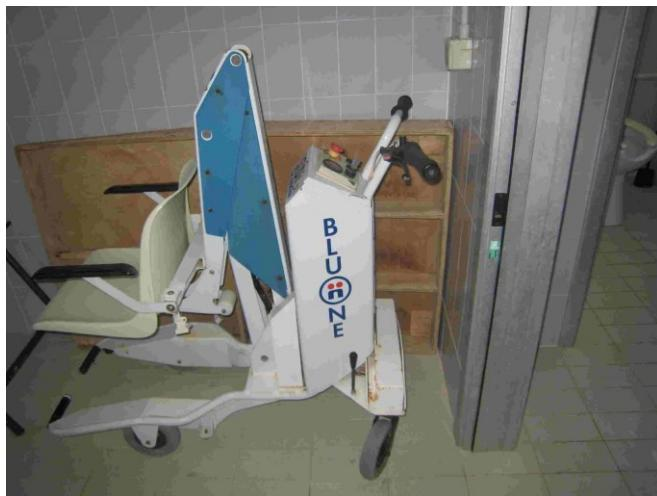
È presente un sollevatore mobile per facilitare la discesa in acqua dell'ospite in carrozzina ed il personale è formato per eseguire tale operazione
