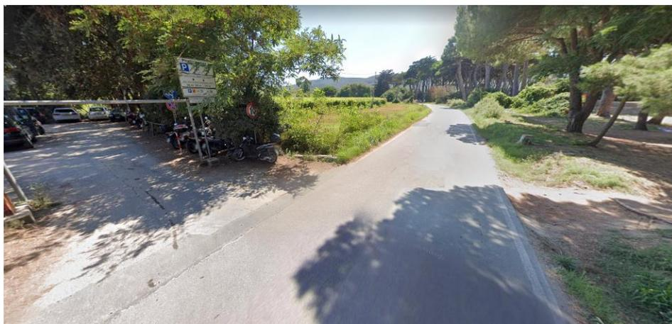
Dal parcheggio, attraversata la strada, per raggiungere il punto di accesso alla spiaggia si deve superare un avvallamento trasversale, di collegamento con il manto stradale, e di cui si raccomanda il riempimento con terriccio compatto, fino a riportare il tratto medesimo in piano. Da qui il percorso prosegue in piano, su fondo sabbioso e sterrato, ma abbastanza compatto, per circa 65 metri, fino al punto di accesso alla spiaggia.
