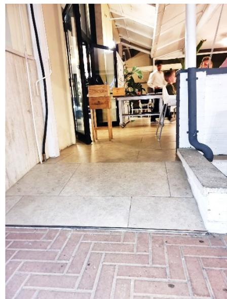
Il **Ristorante** è accessibile da Viale Italia solo tramite una scala con 4 gradini, superabile attraverso un breve percorso laterale, raggiungibile, a lato, da via Alighieri, tramite una prima rampa di raccordo con il marciapiedi, lunga 160 cm, poi una seconda rampa, con pendenza moderata ed infine una terza rampa lunga 110 cm, e pendenza del 20% che permette di raggiungere la sala esterna del ristorante.
